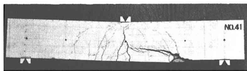
写真-1 最終破壊状況(No. 4.1)
