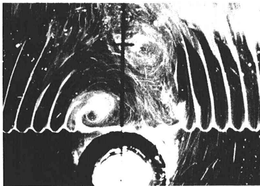
写真-6 逆円錐形洗掘の非対称渦： 写真上が岸側
