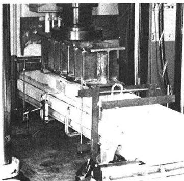
写真-1 振動下注入供試体
