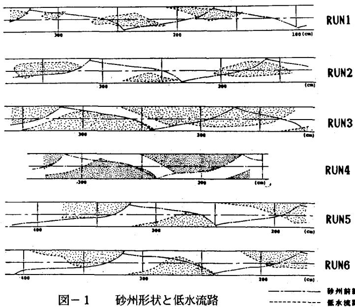
図-1 砂州形状と低水流路
