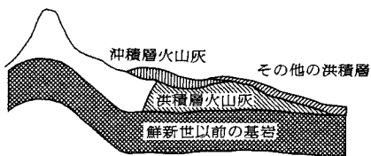
図-11 火山碎屑物堆積地帯のモデル
