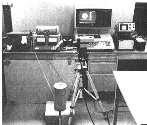
写真-1 赤外線センサによる表面温度測定状況
