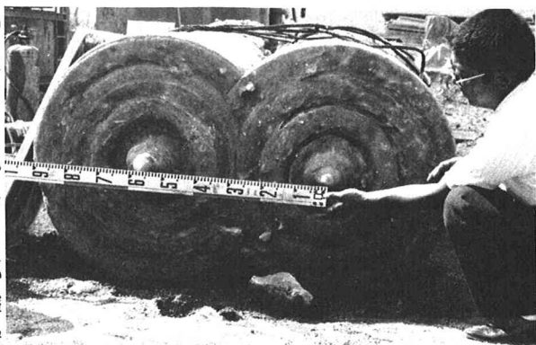
写真-1 地盤改良の先端
