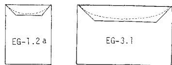
図.2 腹板での塑性関節線
