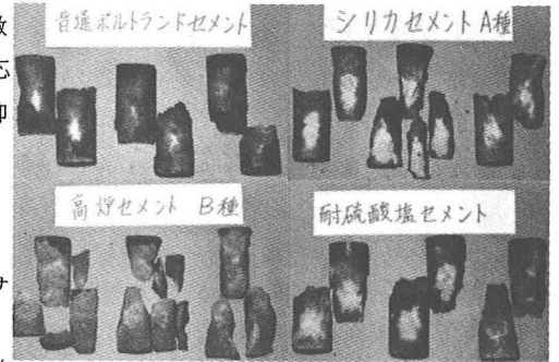
写真-1 原油の浸透状況(2年3ヶ月後)
