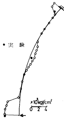
図9 外側鉄筋の応力分布（内側から載荷）
