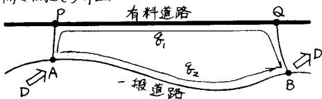
いま図のように2地点AB間に有料道路利用と一般道路利用の2経路があるものとし、それぞれの経路を通る交通量を $\gamma_1, \gamma_2$ 、AB間の需要交通量をDとする。またPQ間の有料道路の料金をpとする。AB間以外の需要交通による有料道路および一般道路の交通量は固定して考える。AB間の有料道路および一般道路を通る経路の走行時間はそれぞれの交通量 $\gamma_1, \gamma_2$ に依存するのでこれらを関数 $t_1 = t_1(\gamma_1), t_2 = t_2(\gamma_2)$ によって表わす。これらは明らかに単調増加関数であり、また交通量が増大するとき走行時間は遞増的に大きくなるので、 $d^2t_1/d\gamma_1^2 > 0, d^2t_2/d\gamma_2^2 > 0$ であると仮定することができる。
