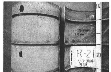
図6 リブ補強試験体の切断図(実験後)
