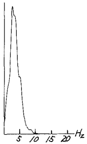
図-5 入力地震波のパワースペクトル
