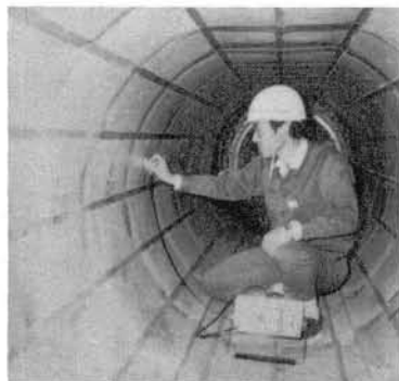
写真-2 ライニング厚を測定している場面
