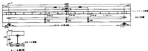
図-1 モデル析の寸法と測定装置配置図
