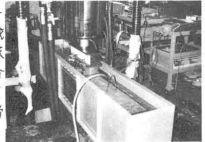
写真-1 水中疲労試験
