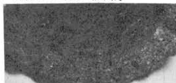
写真-4 PPC ポリマーC 蒸気養生直後
