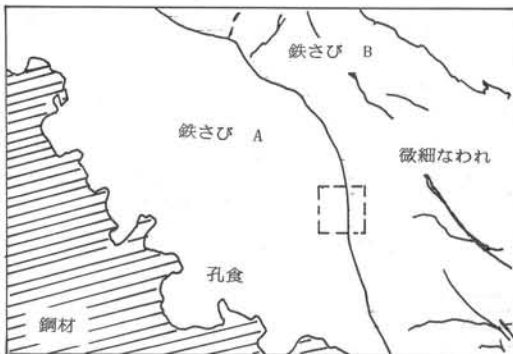
図-2 腐食鉄筋のSEM像(写真-2と同位置)
