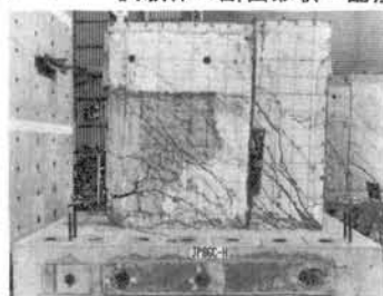
写-1 ひびわれ状況(破壊時)
