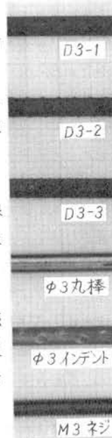
写真-1 D3鉄筋 および3mm鋼材
