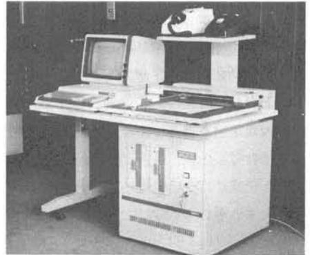
写真-2 山留計測中央処理装置
