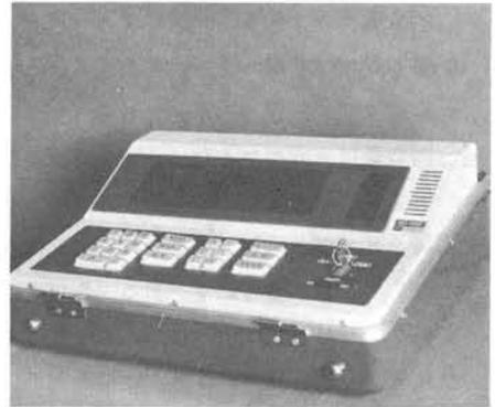
写真-1 携帯用山留計測処理装置
