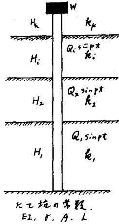
$$(i) \frac{\omega^2 r A}{g} + k > 0 \text{ の場合 } v = \sqrt{(k - \frac{\omega^2 r A}{g}) / EI L}$$
