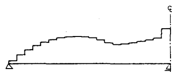
図-5 モーメントの再分配を考慮した 最終モーメントの分配形状
