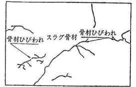
写真-1 骨材ひびわれの成長例 (応力レベル 48%)
