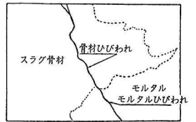
写真-2 骨材ひびわれの成長例 (応力レベル 72%)
