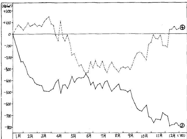
図-3 柱の鉄筋応力
