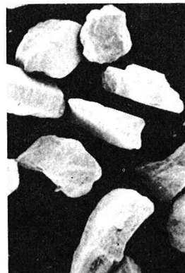
写真-1 乱さないう洪積熱田砂の構造写真
