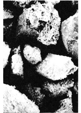
写真-2 ほぐした洪積熱田砂の形状写真
