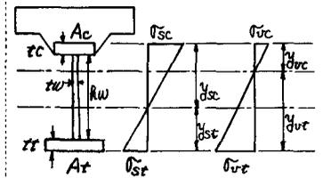
の条件より(1)式から  $dA_c, dA_t$  を求めると(2)式が得られる。現在用いている  $g_c, g_t$  は①寸法制限 ②応力度制限 ③たわみ制限であるが、ここでは②の曲げ応力度で断面が定まる場合を取り上げると  $A_c, A_t$  の変化による  $g_c, g_t$  の変化は(3)式、板厚の変化による  $g_c, g_t$  の変化は  $t_c$  についてのみ例示すると(4)式となる(①  $r_c$  が変化しても床版位置は変化しない。②  $r_c, r_t$  は  $R_w$  に比べかなり小さいと仮定している)。
