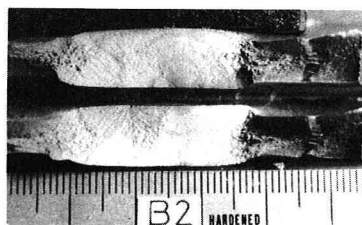
写真-1 疲れ破面
