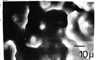
写真-1 粒度: 5~2.5mm モデル溶液: Ca(OH) 2 + 2.0mole% NaOH 溶液
