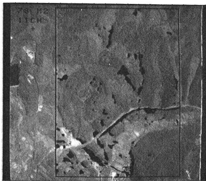
写真1. MSSデータによる活力低下抽出個所(左側)と温度上昇抽出個所(右側) (('77→'78)の経年変化、抽出個所は画像中の黒い領域)
