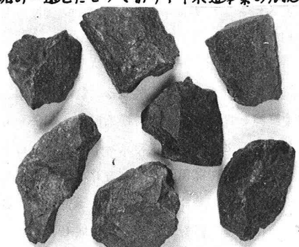
写真 熔融骨材 粒径 20mm
