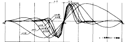
図6 バネ個数と弾性座屈波形 (バネ定数 K = 1791 \text{ t/m} )
