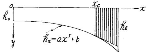
3. 模型実験 厚さ5mmのウレタン板から、 $h_x: h_0 = 50\text{mm}:30\text{mm}$ 、 $60\text{mm}:30\text{mm}$ 、 $80\text{mm}:30\text{mm}$ のそれぞれについて、 $h_x = ax + b$ 、 $ax^2 + b$ 、 $ax^3 + b$ の変断面片持ばりの模型を切り出し、机上で(重力に直交)自由端に任意にかみを与えたときのたわみ曲線の実測値と計算値を示せばつぎの各図のとおりである。
