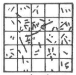
図-3 X方向およびY方向断面上の繊維の配列(繊維混入率はいずれも1.5%vol)
