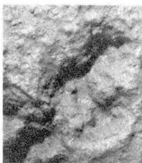
写真-1 砂質土の消石灰-石膏処理土(添加量:2.5% 消石灰:石膏=1:1, 材令:1日)の降雨侵食試験後の供試体表面
