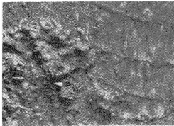
写真-3 ローム層と砂礫層との境界付近壁面状態
