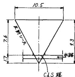
2, 除熱用の薄片A号の設計 シース面は薄く伝熱能力が余り大きくないので2枚の除熱薄片を用い、一つは底面近く(底面より0.7cmの高さ) もう一つは同2.5cmの所に設ける。
