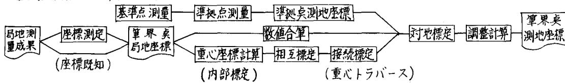
(1) 座標測定 座標測定機を用いて計測する場合、縮尺・方位を原図と必ずしも一致させる必要はない。
