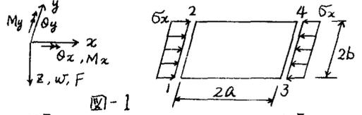
を考える。ここで  $w$ (たわみ),  $\theta_x$ ( $x$ 軸回りのたわみ角)  $= -\frac{\partial w}{\partial y}$ ,  $\theta_y$ ( $y$ 軸回りのたわみ角)  $= \frac{\partial w}{\partial x}$  である。これに対する節点カベクトルは  $\{F_1 \ M_{x1} \ M_{y1} \ F_2 \ M_{x2} \ M_{y2} \ F_3 \ M_{x3} \ M_{y3} \ F_4 \ M_{x4} \ M_{y4}\}^T$  とする。
