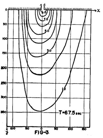
4. 終りに、有限要素法による拡散予測の定式化と簡単な例による解析結果を示した。有限要素法は、任意形状の要素を扱える、境界条件の取り扱いなどで差分法に比較して有利な点が多い。しかし実際的な問題に適用するにあたっては、前述したように単純にはいかない面も多い。今後の課題としては、さらに拡散現象の物理性、例えば鉛直方向の濃度の分布を考慮するとか、流速場との関連を考慮した解析を行なわなければならない。また数値計算の観点からは、形状関数の改良、漸化式の改良、計算誤差の検討なども行なっていく必要があると思う。
