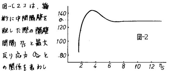
図-2 は、箱桁に中間隔壁を配した際の隔壁間隔  $\eta_s$  と最大反り応力  $\sigma_M$  との関係を表わしている。  $\sigma_M$  は  $\eta_s = 3.5$  付近で最大値をもち、以後一定値に収束しており、この値は中間隔壁を持たない桁の最大反り応力と一致する。この図によれば、箱桁に中間隔壁を配置する際、その間隔が  $\eta_s = 3.5$  付近であれば、並に桁の反り応力を増加させることにおよぼすので、断面変形に伴う反り応力の減少を目的として中間隔壁を配置するならば、その間隔は少くとも  $\eta_s < 2.4$  とせねば、その役割を果し得ないと言えらる。以上の事実より、中間隔壁配置間隔の上限として  $\eta < 2.4$  が定められる。
