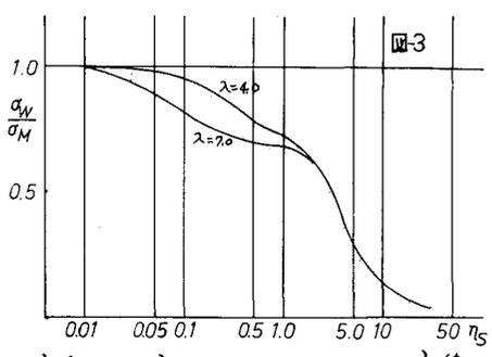
曲げ応力と反り応力の比は下記の式で計算される。
