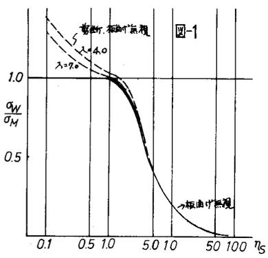
箱桁中央に偏心集中荷重が載荷される時、縦方向にモーメント  $M$  と反り応力  $\sigma_M$  は、曲げの式と同様下記の通り表わされる。
