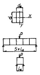
上式で計算される最大反り応力  $\sigma_M$  は Wlassow の解に対し誤差を誘つたが、この誤差は  $\eta_s \lambda$  を用いることにより、図-3 のごとく種々の桁に於て一意的に表示され、左に補正することが可能である。
