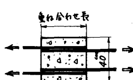
図-4 重ね継手試験
