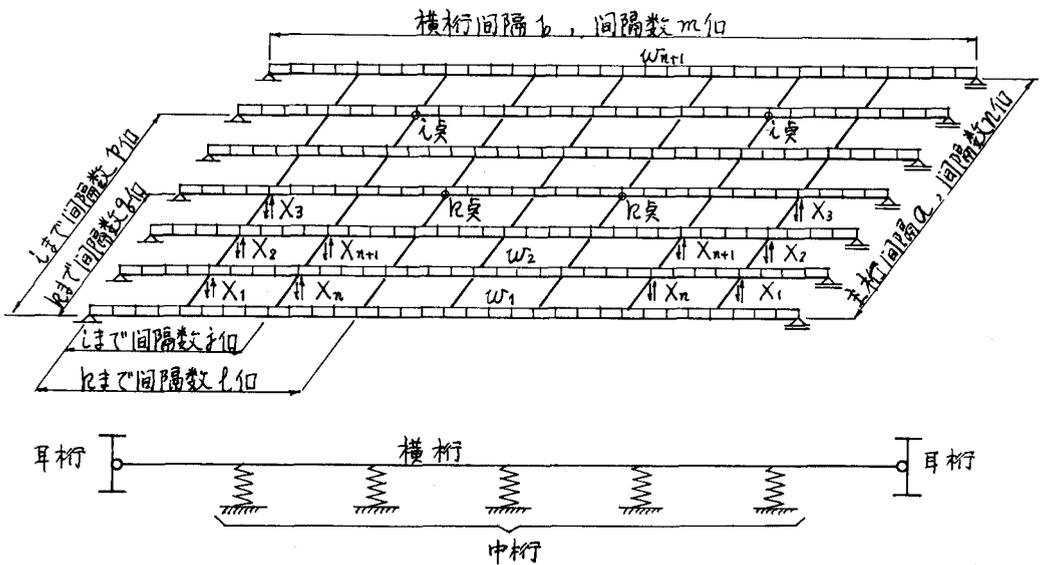
格子桁は図のように両耳桁と鉸結合した横桁とを静定系とし中桁を弾性支承とする。そして中桁と横桁交点に生ずる移行力をそれぞれ  $X_1, X_2, \dots, X_n$  とする。たゞし支間中央を軸として対称であるから、対称な位置の移行力は同じである。これら移行力に関する微分方程式をマトリックス表示すると次のようになる。
