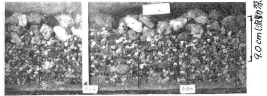
写真1 流れによるふるい分けの1例。こう配20° 粒径21.5mm および7.2mm 通水時間30sec
