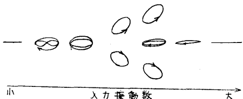
図2. 円柱上端の軌跡の変化の説明図
