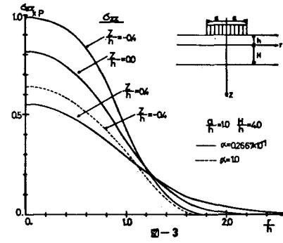
にモデル(A)の応力  $\sigma_{zz}$  図を図-3 にモデル(B)の  $\sigma_{zz}$  図を示す。又、図-4、図-5 にモデル(A)、(B)の応力  $\sigma_{rz}$  を、図-6、図-7 にモデル(A)、(B)の応力  $\sigma_{rr}$  を示す。以上の結果より  $E_1$ (上層板の弾性係数) <  $E_2$ (下層板の弾性係数) のとき、応力  $\sigma_{rz}$  は均一床板比較すると二層板の場合には、上層に応力が大きい。それから上層、下層板の弾性係数比  $E_1/E_2$  の影響を受ける。
