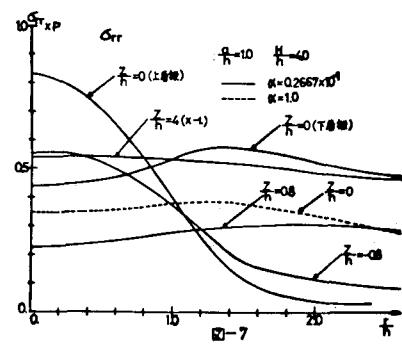
。応力  $\sigma_{rz}$  は上層、下層板の弾性係数比  $E_1/E_2$  が小さくなると下層板の応力が大きくなる。モデル(B)では上層、下層板の境界面附近で応力の集中が見られる。又、 $\alpha = 1$  に近づく程上層に応力が集中する。
