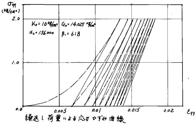
繰返し荷重による応力ひずみ曲線
