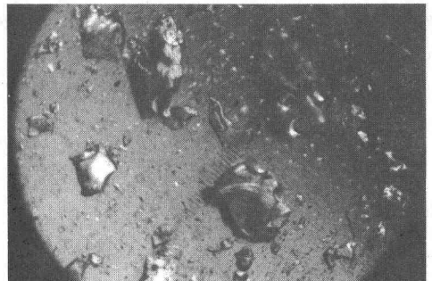
写真-1 高炉スラグの顕微鏡写真
