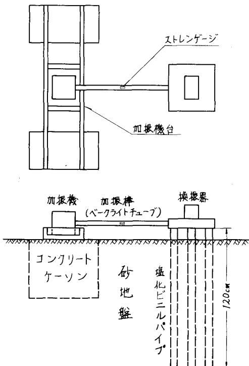
図の様な装置を用いて, 発振器より正弦波を送り, 变位ヒ加振力を電磁オシログラフで記録し, 一方デジタルカウンターで周波数又は周期を読んだ。低サイクル試験は変位一定(30~50ミクロン)で行なった。共振点付近は加振力一定(300~500g)で行い, 得られた結果から共振曲線を描いて共振点を求めた。
