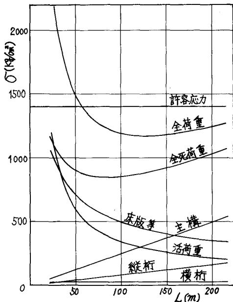
図-2 直弦ワレントラス(7-9)部材における応力  $\sigma$  とスパン  $L$  の関係
